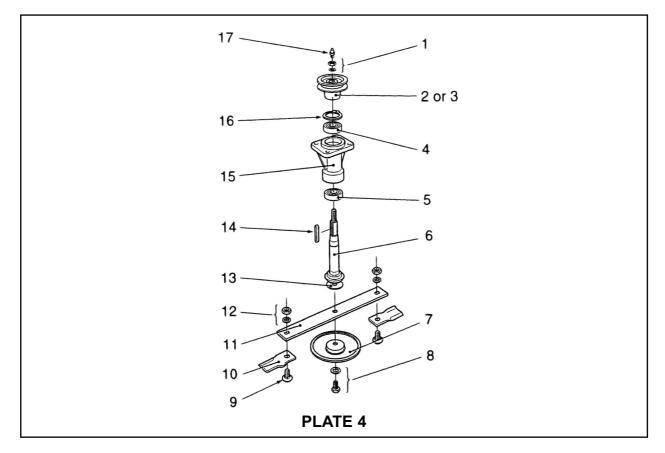
PARTS LIST - SPINDLE & BLADE ASSEMBLY (4 Wheel Mower)
