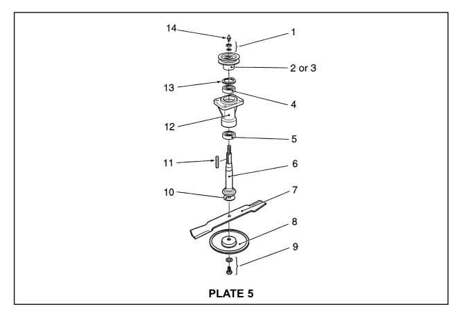
PARTS LIST - SPINDLE & BLADE ASSEMBLY (2 Wheel Mower)
