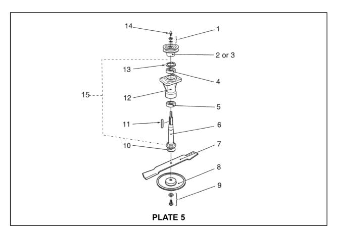
PARTS LIST - SPINDLE & BLADE ASSEMBLY (2 Wheel Mower)
