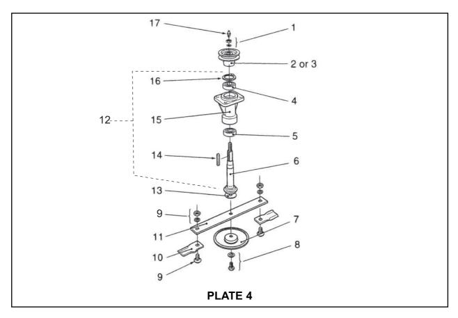
PARTS LIST - SPINDLE & BLADE ASSEMBLY (4 Wheel Mower)
